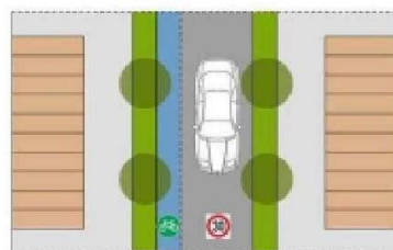
SCHEMA VIABILITÀ INTERNA AI SETTORI: viale alberato a senso unico di circolazione con pista ciclabile e marciapiedi in sede propria.
