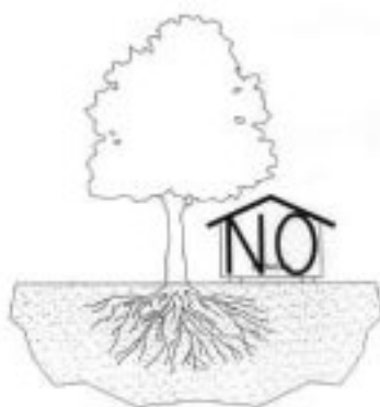
Fig. 6 Divieto di occupare il terreno in prossimità dell'albero.
